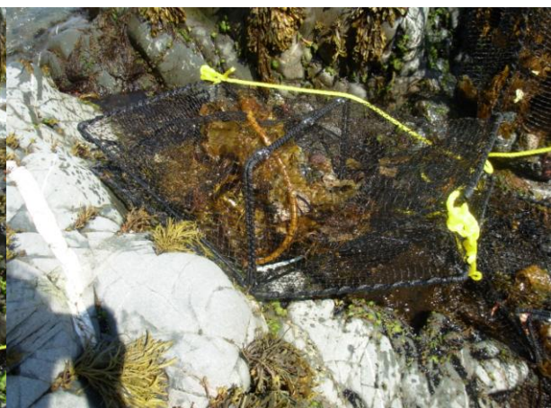
Figure 35 : Casier déformé par la houle juste après la pose à la station du fond de l'anse de Miquelon (Photo : ARDA, 2013)
