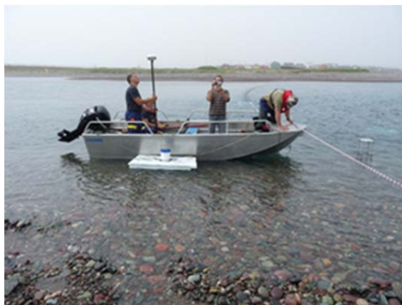
Figure 13 : Acquisition conjointe DTAM/Ifremer à l'aide d'un courantomètre Doppler "Top-Bottom" et d'un DGPS pour acquisition des vitesses de courant sur la section et raffinement du profil bathymétrique du site de mesures.
