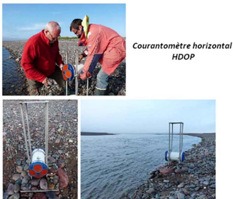
Figure 10 : Courantomètre transversal : montage de la structure porteuse (photo du haut), dispositif en place (bas, gauche) et vue générale (bas, droite).
