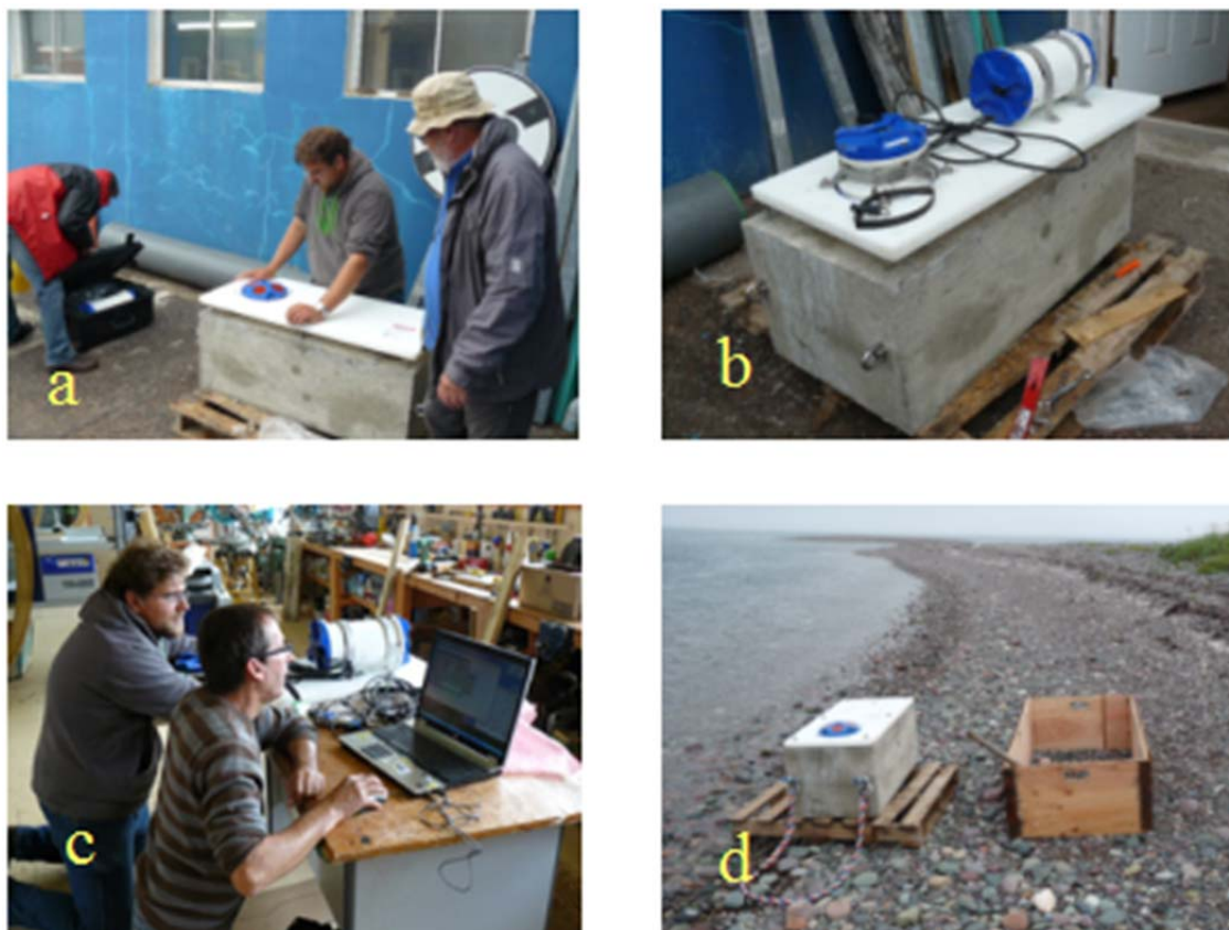
Figure 11 : Préparation du dispositif d'installation du courantomètre vertical : a) sarcophage de protection b) dispositif complet avec le courantomètre et ses piles (en position inverse de l'acquisition) c) calibration de l'appareil d) système complet, courantomètre en position dans le sarcophage et coffre de protection pour mise à l'eau.
