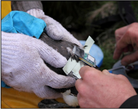
Pose des émetteurs GPS ; à gauche un GPS Catnip sur une Guillemot de Troil, à droite un GPS Pathtrack avec panneaux solaires sur un macareux moine.
