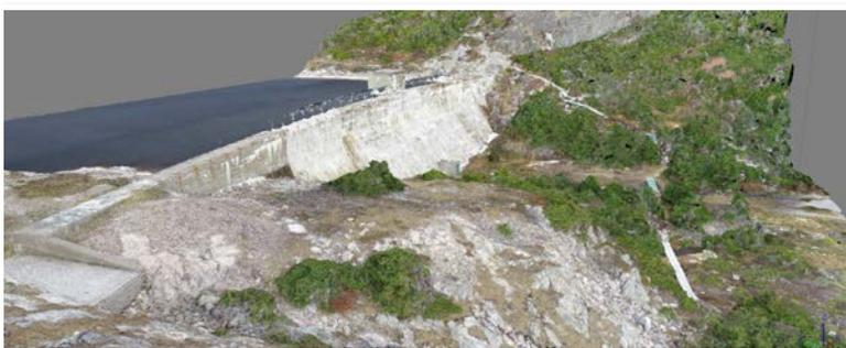
Exemple d'utilisation du drone : lever topographique et photographie 3D réalisés dans le cadre de la réhabilitation du barrage de la Vigie.
