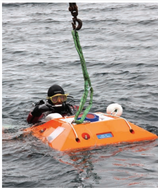
Les équipes de l'unité Port, Phares et balises (marins, plongeurs et techniciens), travaillent de concert avec les services techniques nationaux pour positionner, entretenir et recueillir les données des différents instruments de mesure. Ici un courantomètre.
