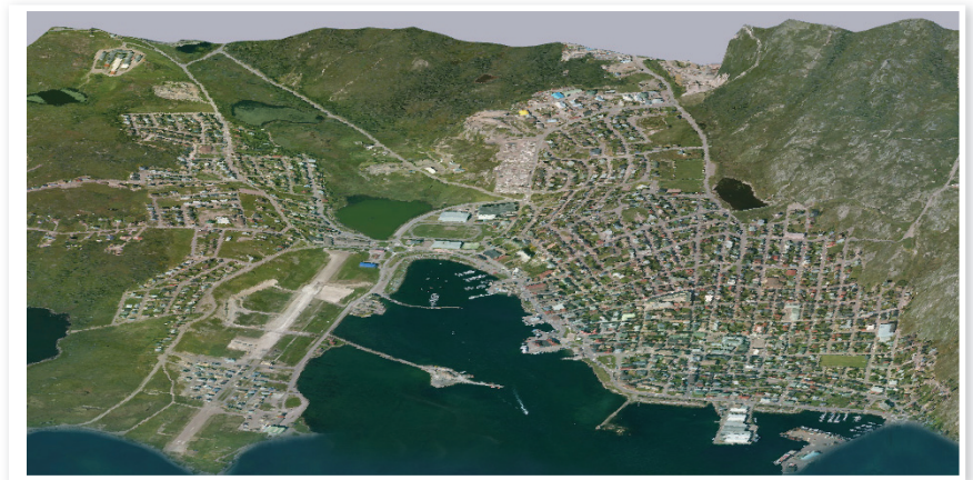
Modélisation 3D de la ville de Saint-Pierre obtenue en associant les données topographiques 2017 du levé LiDAR à la photo aérienne IGN.
