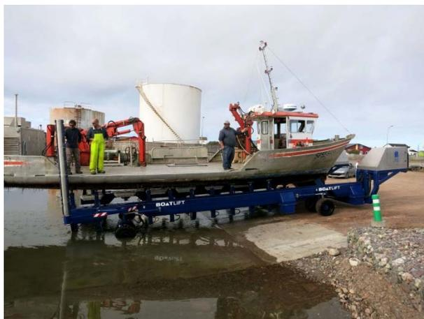
**Figure 34 : Ber hydraulique de Miquelon en essai**
