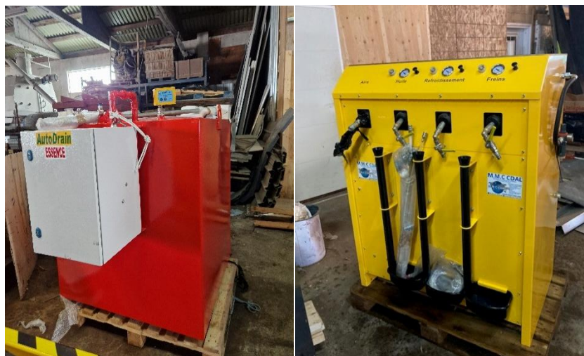
Figure 8 : Système dépollution AutoDrain (Huile, liquide frein, liquide refroidissement et essence)
