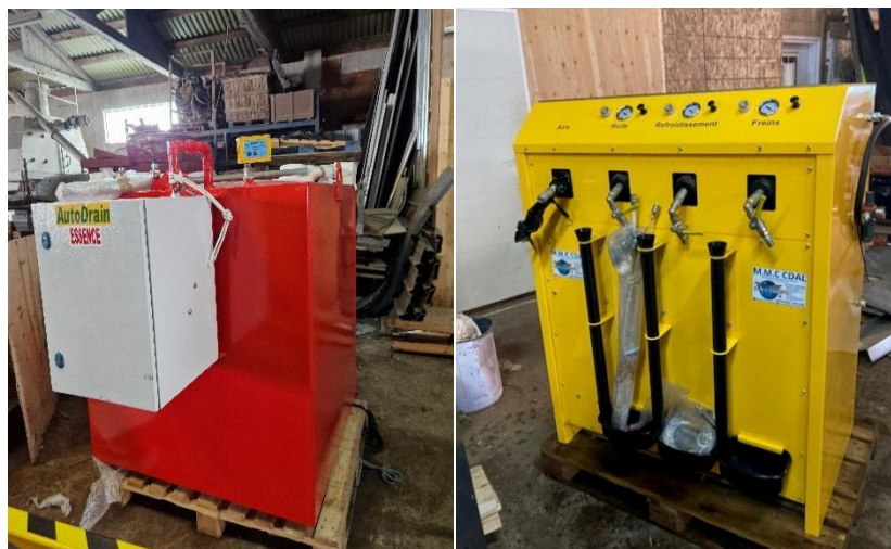
Figure 7 : Système dépollution AutoDrain (Huile, liquide frein, liquide refroidissement et essence)
