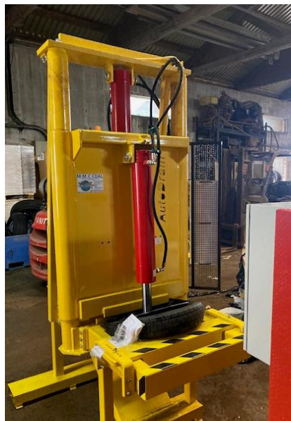
Figure 6 : Machine à démonter les pneus (déiateur) et bidons stocké sur rétention)
