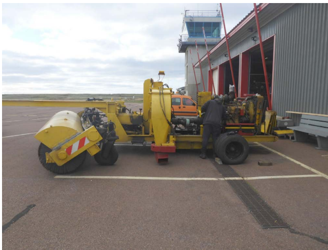
Remplacement du moteur de la balayeuse de l'aérodrome
