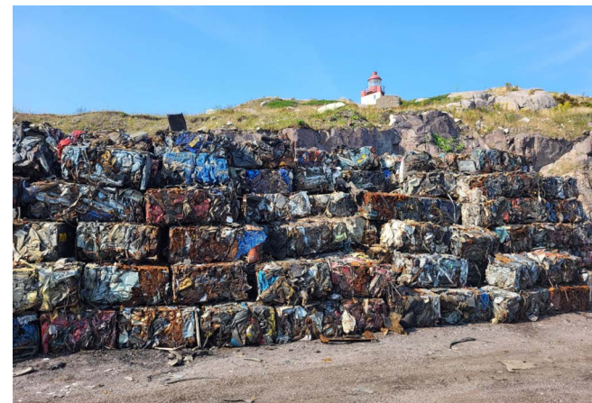
Stock de VHU broyés puis compactés
