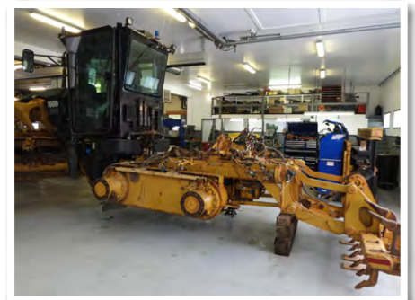
La réfection de la niveleuse a représenté un chantier d'envergure pour l'atelier.
