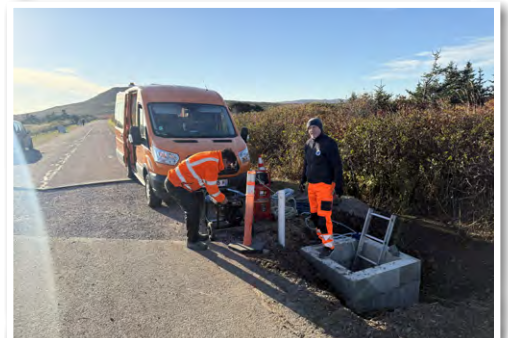
Vérification de l'étanchéité d'un réseau busé EU (eau usée) par les agents du laboratoire BTP.
