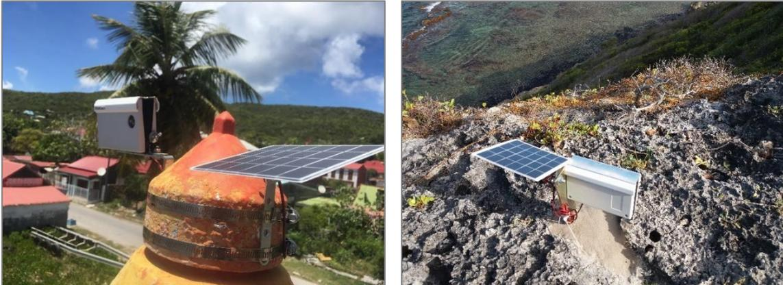
*Illustration 77 - Dispositif de suivi par imagerie vidéo de type SolarCam®, utilisé en Guadeloupe pour le suivi des échouages de sargasse et de l'évolution du trait de côte*
