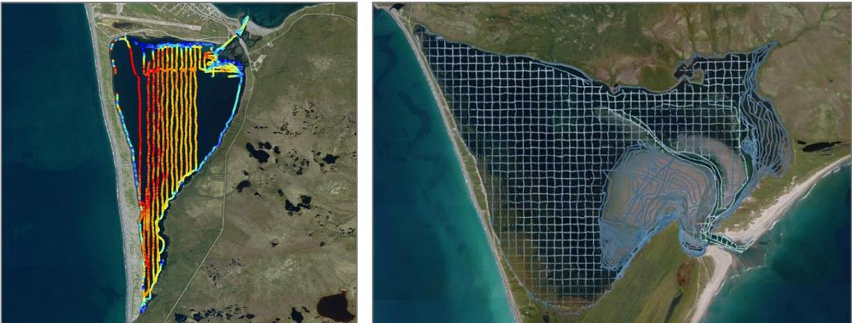
*Illustration 78 – Suivi bathymétrique des lagunes du Grand Etang de Miquelon (à gauche) et du Grand Barrachois (à gauche) réalisé par la DTAM*
