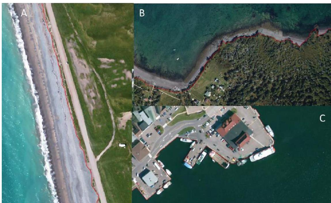
Illustration 20 - Exemple de délimitation du trait de côte utilisé par De La Torre et al. (2016) : A. limite de végétation ; B. limite de haut de versant ; C. limite en pied d'aménagement (Bd Ortho IGN 2005)
