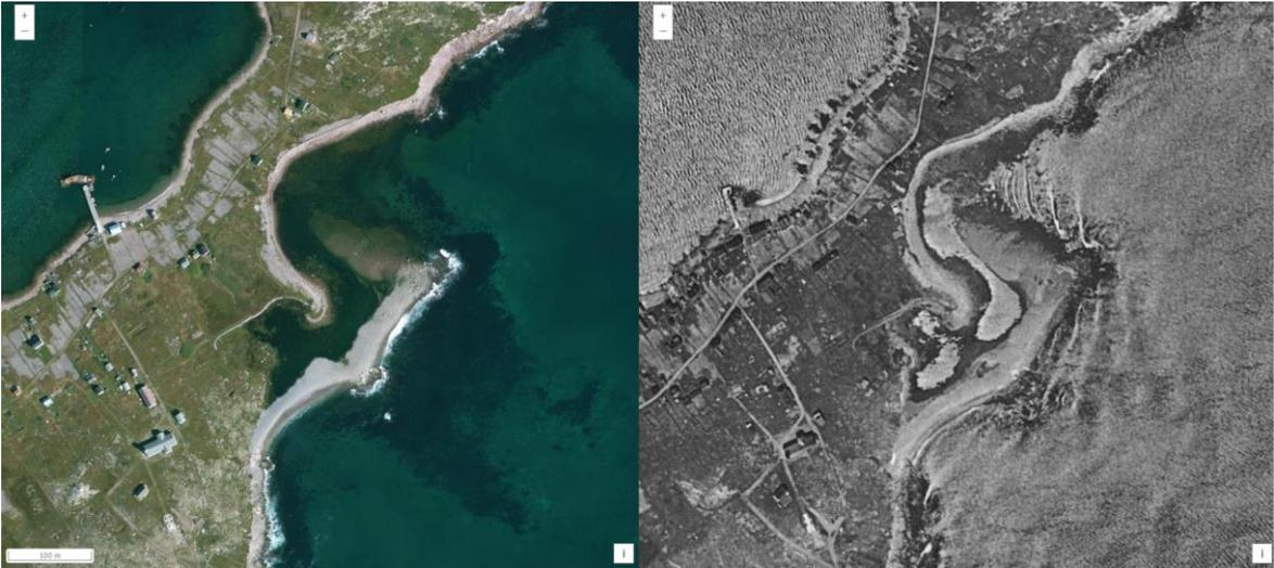
Illustration 40 – Rupture au niveau de la flèche de galets sur la façade est de l'île aux Marins : photographie en 1952 à droite et 2005 à gauche (IGN)
