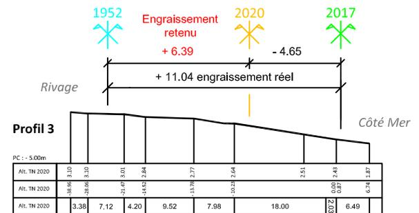
La méthode utilisée pour le calcul de l'érosion ou de l'engraissement se fait par transect (profil en travers) et trait de côte (profil en long).
